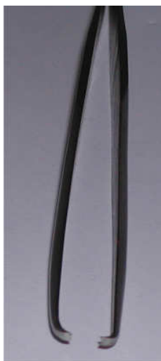
Kuva 7: Omatekoiset kuorintapihdit (Tomi Engdahl)
