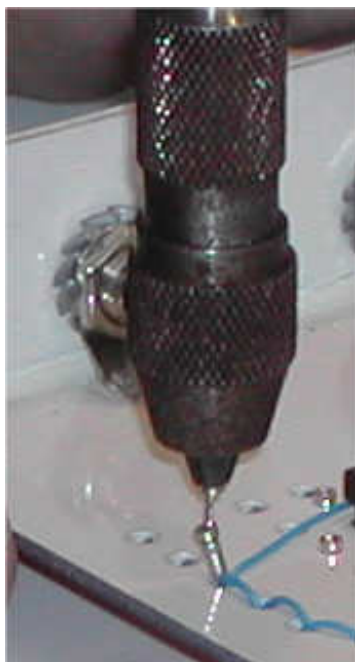
Kuva 9: Holkin asennustyökalu porakoneeseen kiinnitettynä (Tomi Engdahl)
